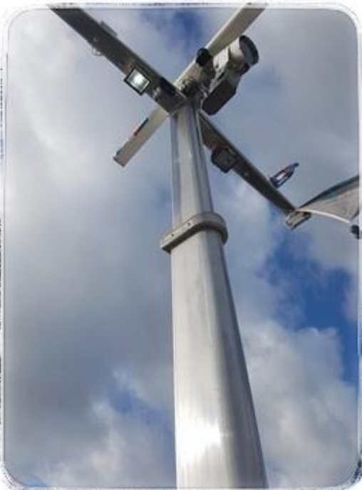
Dubbel uitschuifbaar met D-model vleugels en clinosysteem ingebouwd
