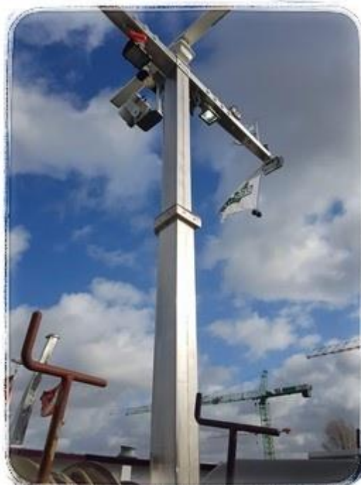
Dubbel uitschuifbaar met D-model vleugels en clinosysteem ingebouwd
