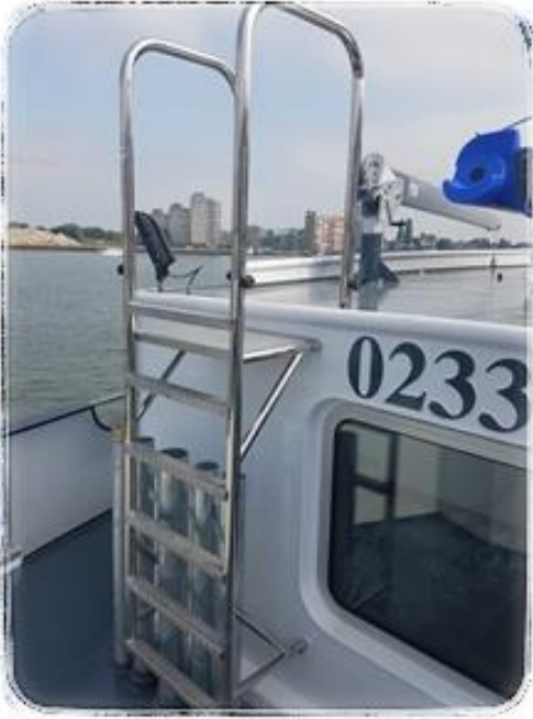
Rvs roefladder met wegneembare gepolijste leuningen
