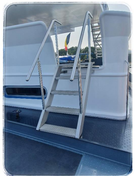
Tankdekramp rvs met gepolijste leuning
