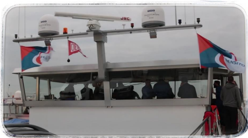
Type Oriana (Cosmic) met radar en twee schotelsteunen, en alle kabels binnendoor
