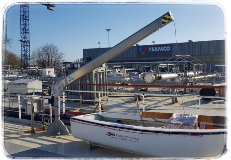
ATEX 300 kg versie met elektrische lier en schakelkast
